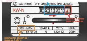
*Рис. 42.* Шкала учета электрической энергии механического счетчика. Черным цветом указываются кВт.ч. Красным – текущий расход энергии в долях кВт.ч. Оранжевым – выделено количество оборотов для 1 кВт.
