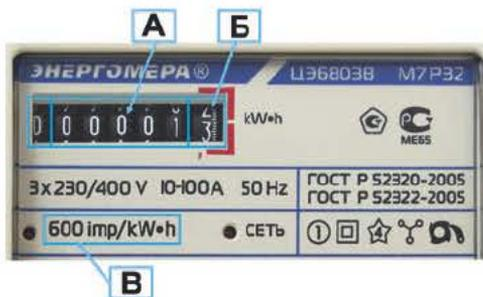
Рис. 119. Счетчик электрической энергии
