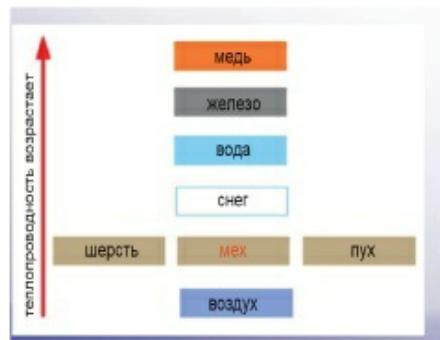
Рис. 82. Теплопроводность различных веществ
