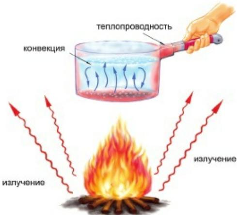
Рис. 54. Виды теплопередачи
