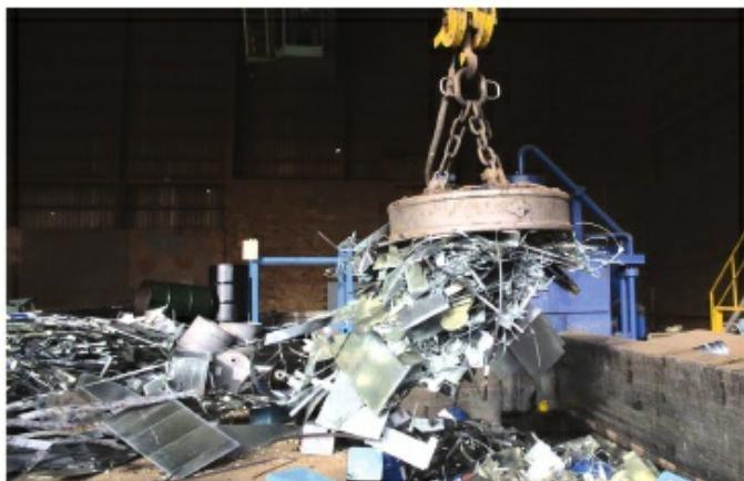
Рис. 92. Электромагнитный кран
