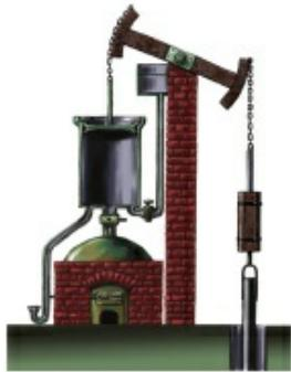
Рис. 213. Паровой двигатель
