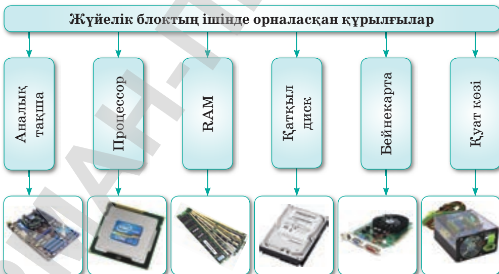
4-сызба. Жүйелік блоктың ішкі құрылғылары
